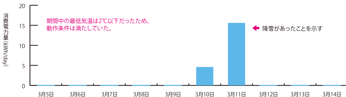
融雪ヒータの消費電力量
